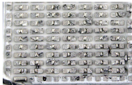
図8 多数のP型半導体とN型半導体の対を並べた実際のペルチェ素子の内部
