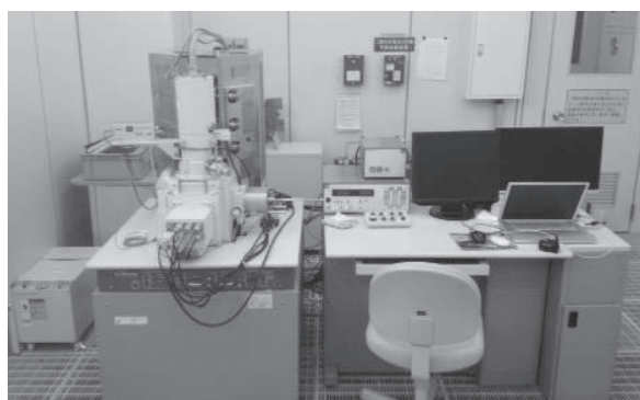
図2:クリーンルームクラス100に移設後のショットキーエミッション型走査電子顕微鏡(S4300SE 日立ハイテクノロジー)に、東京テクノロジー社と共同開発した描画システムを実装したシステム。(2次電子像分解能1.5nm(30kV)、通常観察倍率50-50,000倍)
