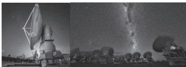
図1:(左) 報告者の太陽系地球型惑星の大気環境監視専用電波望遠鏡(口径10m)。高度1350mの野辺山宇宙電波観測所にて運用し、大阪府立大から遠隔制御している。(右)チリ共和国の標高5000mアタカマ高地に建設された日・欧・米のALMA国際望遠鏡群。いずれの望遠鏡にもSIS超伝導検出素子を搭載している。ALMAではテラヘルツ帯への拡張も期待されている。
